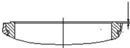
Figura 6: La brida de la camisa del cilindro está más alta que la parte superior del bloque del cilindro.
