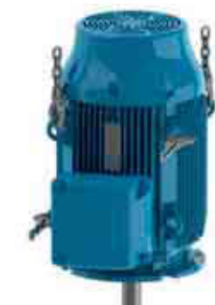
Figura 4.17 - Instalación del segundo par de cáncamos
