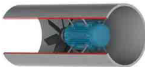
Figura 6.8 - Representación de la fijación del motor en el interior de un conducto de ventilación
