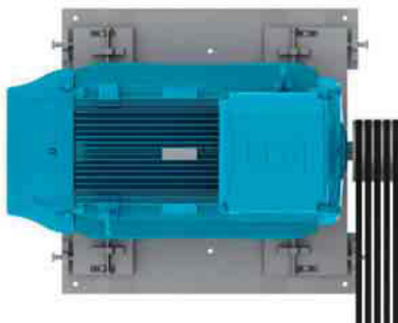
Figura 6.4 - Motor instalado sobre base deslizante
