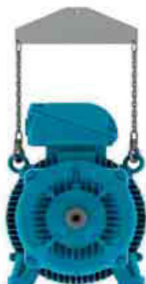
Figura 4.6 - Uso de barra separadora en la elevación
