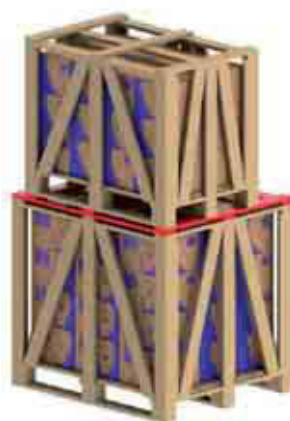
Figura 5.5 - Utilización de varas adicionales para apilamiento
