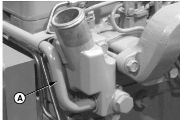
Tubo entre la cubierta del termostato y la bomba de agua
