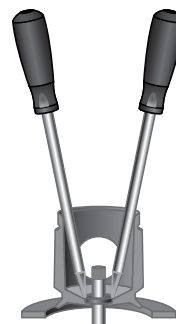
Figura 8: Remoción del sello mecánico
